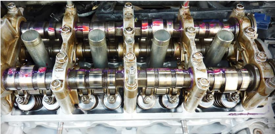
Slika 07.01 Vijčani spojevi dijelova motora SUI ( glava/bregasta/ventili )
